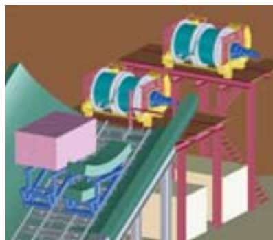
Mit Winden und Wagen wird die Tunnelvortriebsmaschine bedient.
