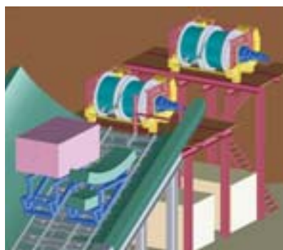
Mit Winden und Wagen wird die Tunnelvortriebsmaschine bedient.
